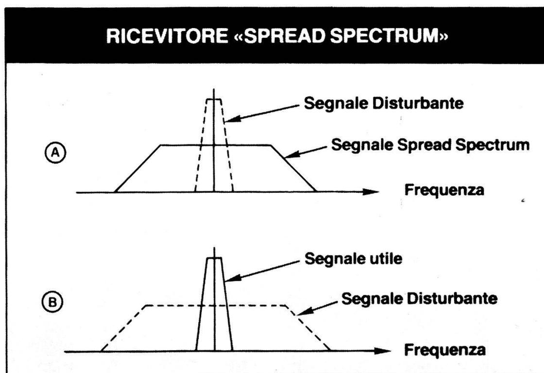
Comportamento di un ricevitore *spread spectrum* in presenza di un segnale disturbatore a banda stretta. Disegno A: all'ingresso del ricevitore il segnale disturbante ha un livello superiore allo *spread spectrum*. Disegno B: compressione del segnale *spread spectrum* e dispersione del disturbo nel ricevitore.
