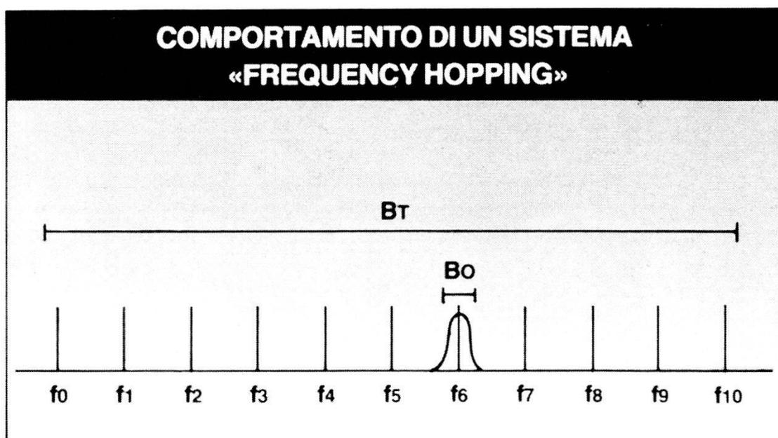
Comportamento di un ipotetico sistema *frequency hopping* in grado di saltare su 11 frequenze, indicate con i simboli  $F_0 \dots F_{10}$  nell'unità di tempo.  $B_0$  è la larghezza del segnale,  $B_t$  la larghezza di band complessivamente impegnata nell'unità di tempo.
