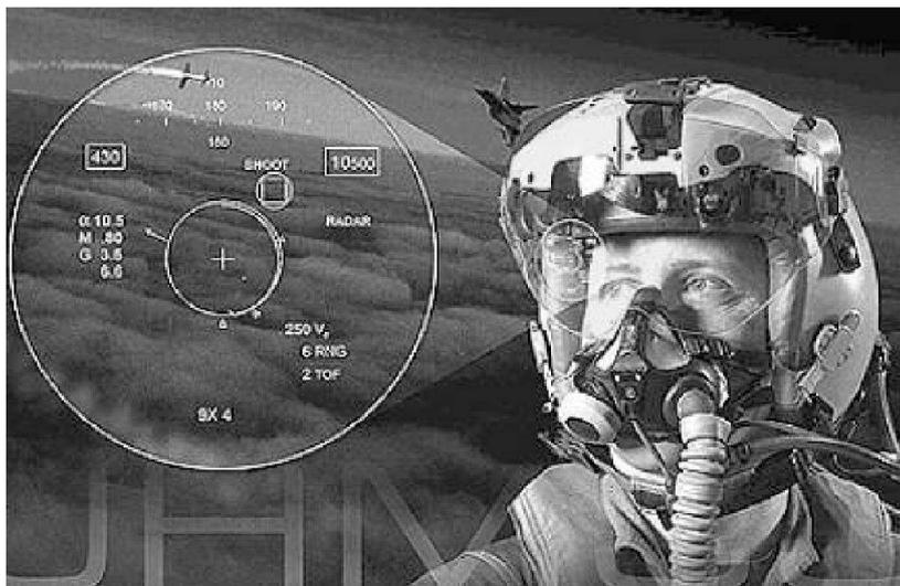
Con il nuovo casco si sfrutta al massimo le possibilità d'impiego del missile AIM-9X ottenendo notevoli vantaggi operativi. Grazie a un sistema elettro-ottico la testa del missile segue automaticamente i movimenti della
