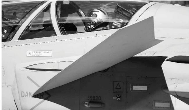
Le alette canard non comportano soltanto una maggiore agilità del velivolo alle basse velocità, ma abbreviano pure e in modo rilevante la distanza di frenata all'atterraggio. La parte posteriore della fusoliera è munita pure di due ipersostentatori frenanti.
