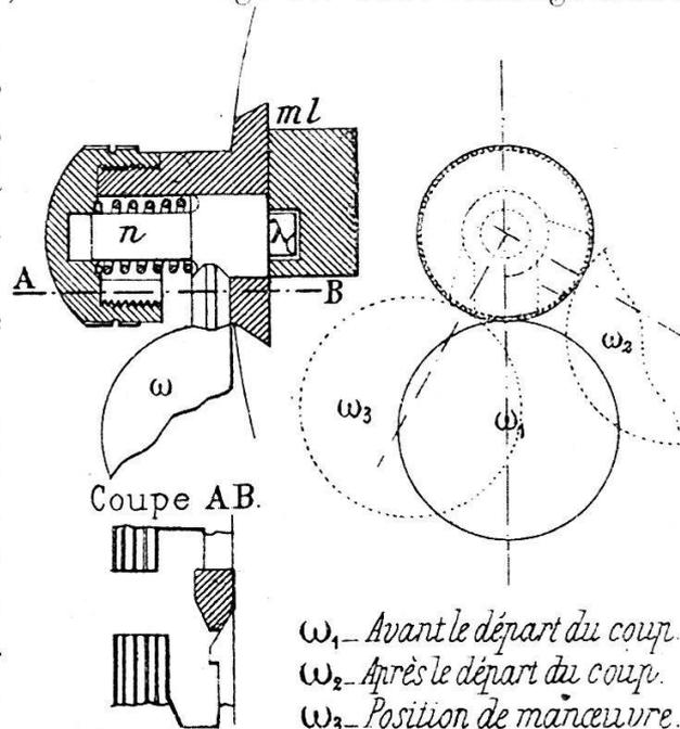
qu'au départ du coup. A ce moment et par la production du recul de la pièce, ce balancier, en vertu de son inertie, se trouve ramené vers l'arrière. En raison de la construction de la tige et de la disposition du logement correspondant, ce mouvement produit un recul de l'ergot vers la gauche, de telle sorte que rien ne s'oppose plus au refoulement de  $ml$  dans son logement par l'effet de la pression exercée sur le bouton du levier.
