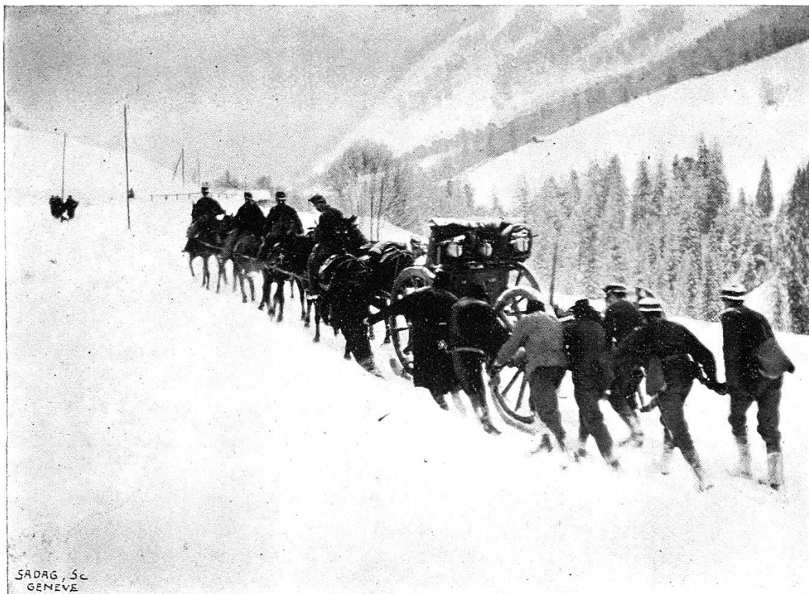
FIG. 8. — Pièce à lugeons antérieurs et postérieurs, entre Sépey et Comballaz; traction pénible, malgré le peu de neige, la faiblesse de la pente et le renforcement de l'attelage.
