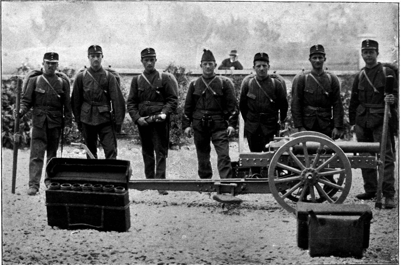
Canon de montagne Krupp de 7,5 cm. à tir rapide, à long recul, modèle 1901.
