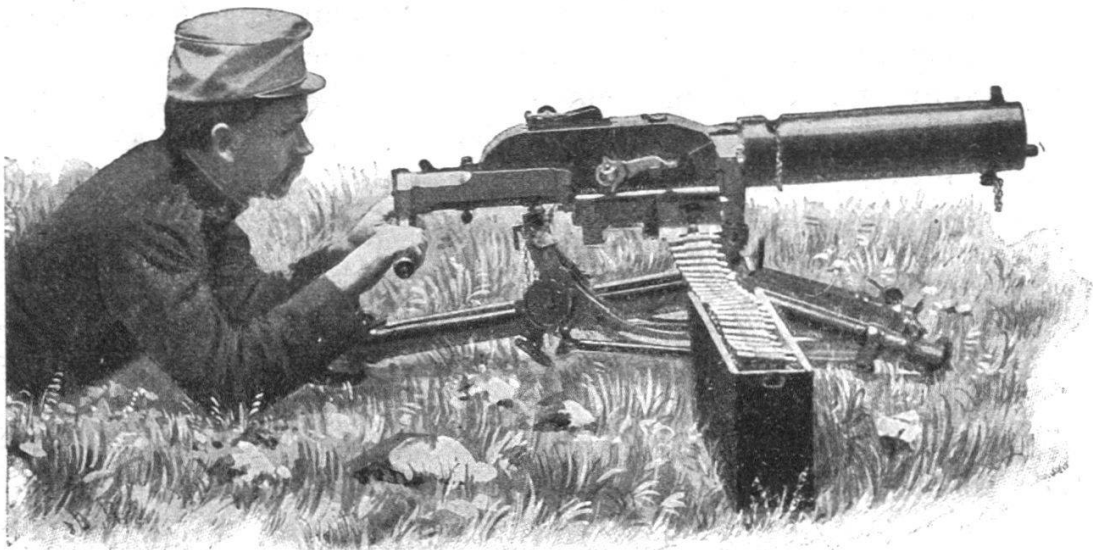
Fig. 2. — Mitrailleur Schwarzlose au tir, dans sa position la plus basse.
