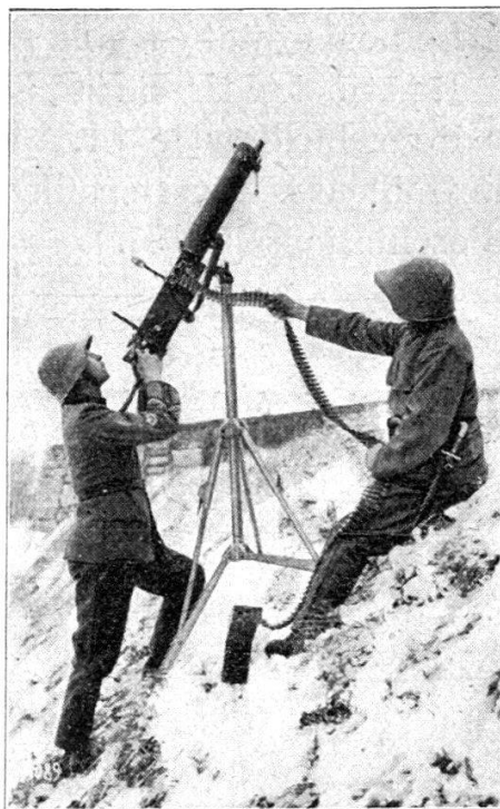
Fig. 5. Mitrailleuse sur affût spécial pour le tir contre avions. La mitrailleuse est munie du correcteur, de la crosse et du cache-flammes.
