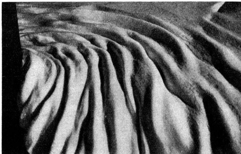
FIG. 7. — Compression de la neige devant un obstacle. Cas typique montrant la plasticité de la neige.
