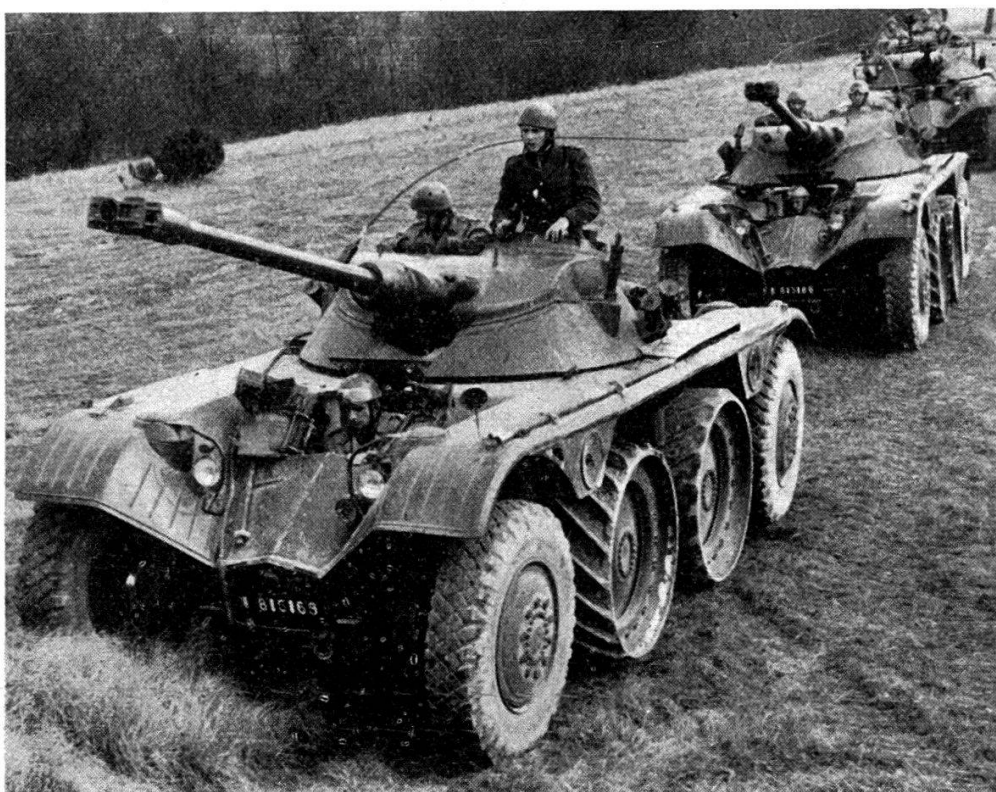
FIG. 2. — Engin blindé de reconnaissance (EBR). A noter les roues centrales à crampons obliques pouvant être abaissées pour le parcours en terrains variés. Il y a deux conducteurs : l'un à l'avant, l'autre à l'arrière. Autonomie : 400 km.
