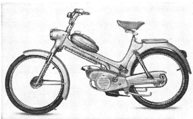
moteur refroidi par turbo-ventilateur puissance en côte = 19 %.
