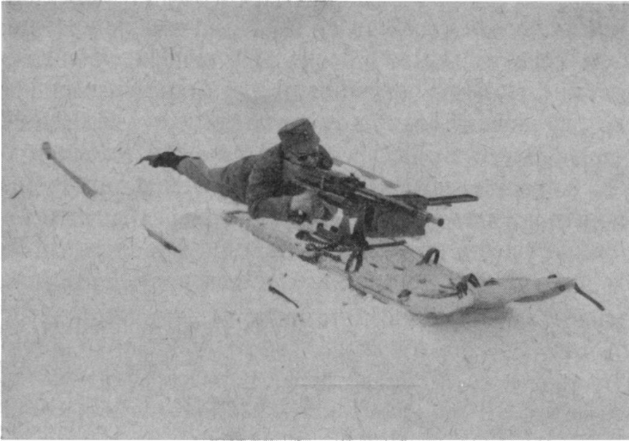
FIG. 7. — La mitr. 51 sur luge canadienne, en position de feu, sans trépied.
