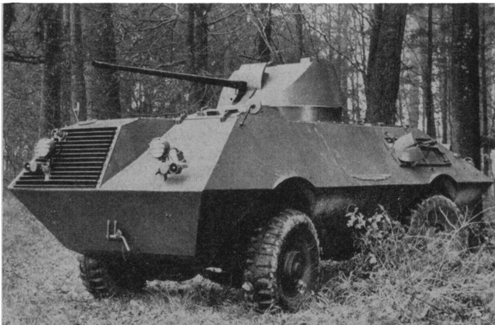
FIG. 3. — Véhicule blindé MOWAG à usages multiples, armé d'un canon de 2 cm
