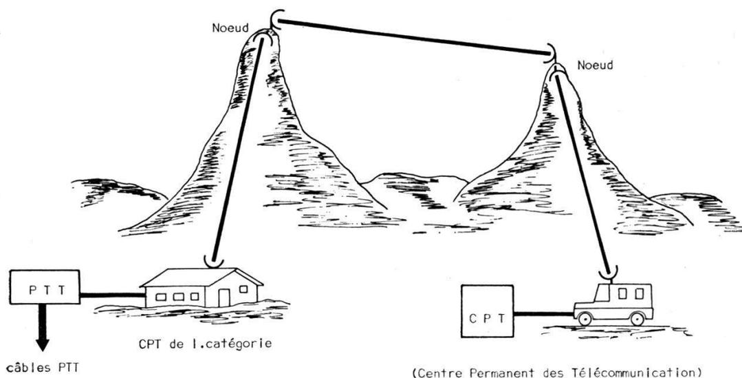
Fig. 5a. Représentation schématique du réseau à ondes dirigées de l'armée (ondi)
