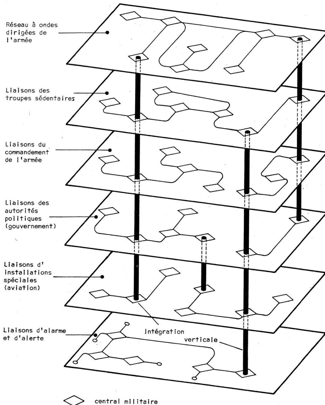
Près de la moitié des réseaux permanents de l'armée sont basés sur le système du réseau câble des PTT (câbles locaux, régionaux ou interurbains) alors que le solde est constitué par les câbles ou le réseau à ondes dirigées de l'armée (fig. 2).
