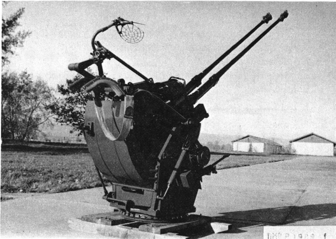
*Figure 6. — Canon DCA 20 mm 54 sur socle «Zwilling».*
