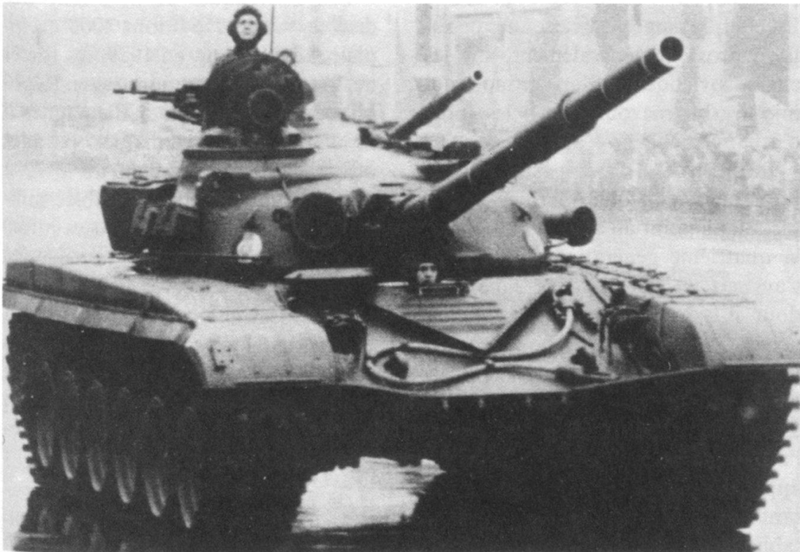
T-72 à un défilé. La pièce en V devant l'écouille du pilote empêche l'eau d'atteindre le poste de pilotage, lors d'un passage à gué. A droite de la tourelle, le schnorchel.
