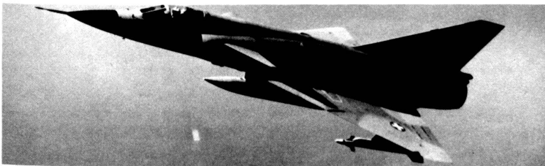
Avion de combat Mirage On distingue les nouveaux ailerons avancés, dits « Canard », posés à Emmen
