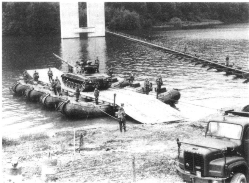
Le matériel des troupes du génie doit être modernisé. Ici des éléments du pont flottant engagés comme bac. Le vieillissement de ce système est inquiétant...
