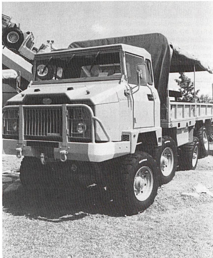
La version 8x8 du VLRA a jusqu'à 60% de pièces en commun avec le 6x6. (Photo RMS)
