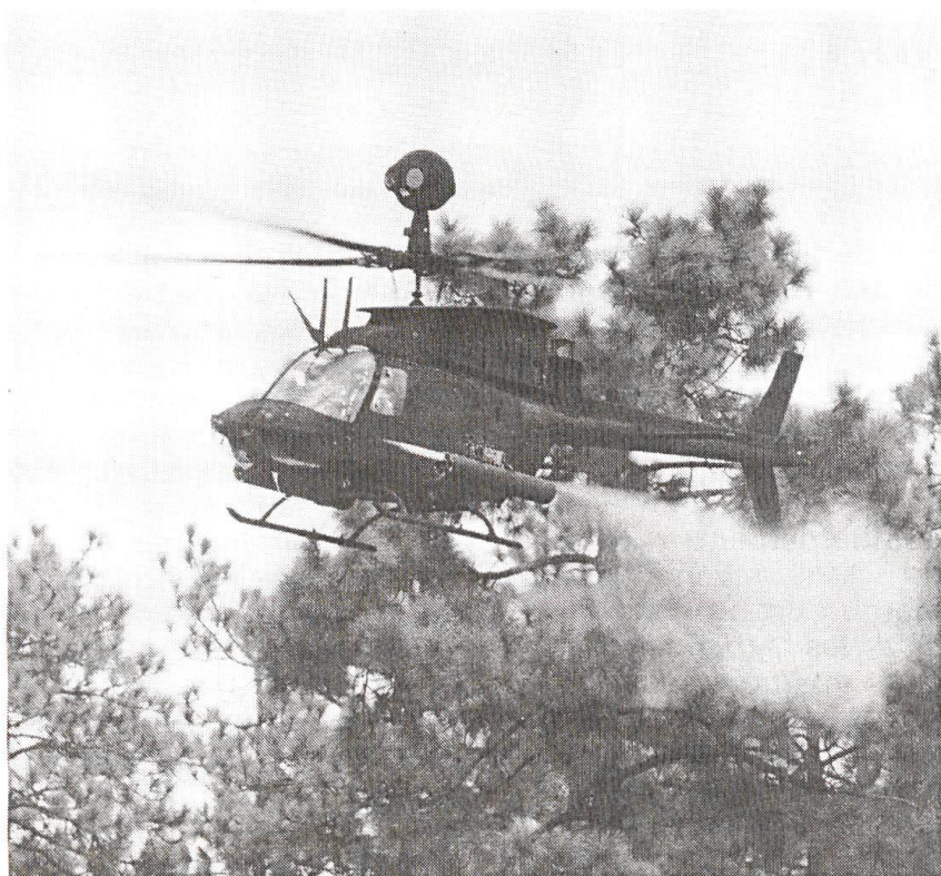
Les hélicoptères de la dernière génération disposent d'amplificateurs de lumière qui leur permettent de combattre de nuit... (Photo Bell Helicopter Textron).
