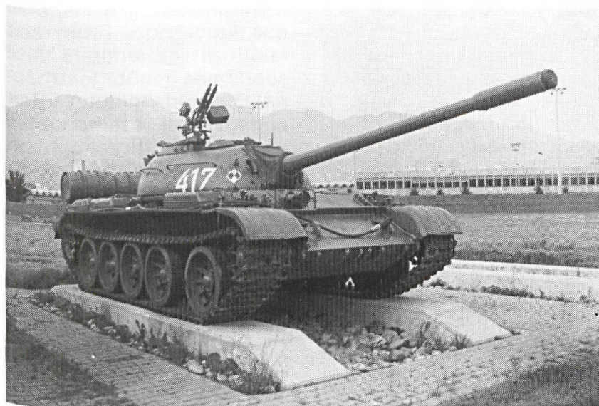
Vue générale trois quarts avant, on distingue les deux types de galets de roulement et le support de la mitrailleuse DCA de 12,7 mm. La «main courante» autour de la tourelle permet à l'infanterie de s'agripper au char en marche.
