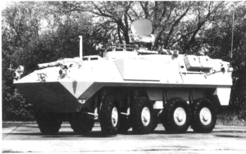
Le radar Rasit sur Piranha 8x8, un exemple d'utilisation compatible avec les matériels déjà en service dans l'armée suisse. Un tel montage serait possible sur le véhicule d'exploration 93, par exemple, avec une représentation graphique automatique – sur carte – de l'image radar. (Photo Thomson)
