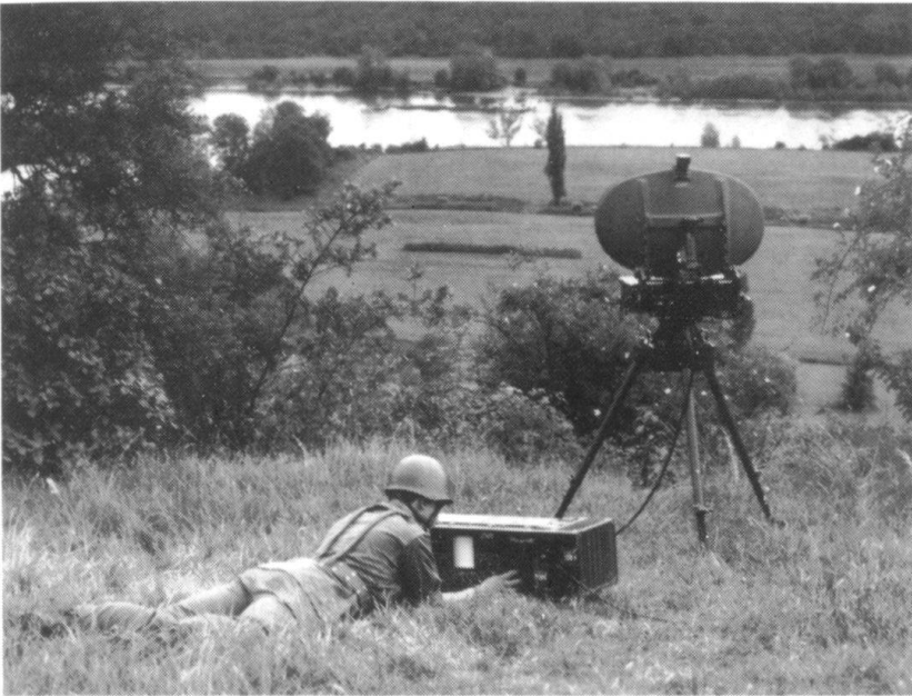
Le radar de combat Rasit de la firme Thomson-CSF, utilisé dans 20 pays pour la surveillance du champ de bataille, la surveillance de frontières et d'objectifs sensibles, pour la correction des tirs d'artillerie (jusqu'à 30 km pour l'artillerie de 155 mm). Il permet la détection d'un piéton jusqu'à 23 km, d'un hélicoptère jusqu'à 30 km et d'un véhicule blindé jusqu'à 40 km. Ce type d'équipement est en accord parfait avec les nouvelles missions de l'armée. (Photo Thomson)
