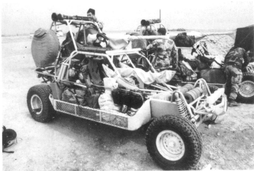
Le Light Strike Vehicle (LSV) dans la configuration utilisée par les US Marines Recon Teams (avec 1 mitrailleuse M2 HB de 12,7 mm et 1 mitrailleuse M60E3 de 7,62 mm) pour l'exploration en profondeur. Léger, rapide (130 km/h), très maniable et offrant une signature radar et thermique minimales, le LSV peut évoluer facilement en territoire ennemi. Depuis la guerre du Golfe, les forces spéciales britanniques (SAS), portugaises et françaises se sont équipées de véhicules similaires. (Photo Chenoweth)
