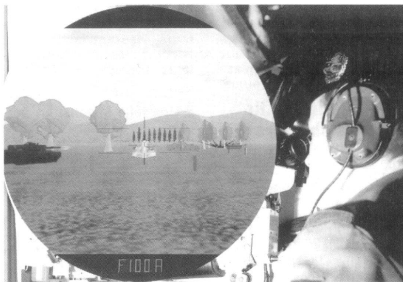
Ce que voit le pointeur dans le simulateur ELSALEO. L'ordinateur génère en temps réel des images en couleur d'un terrain d'exercice de 7 x 10 km (Photo Krupp Atlas Elektronik).
