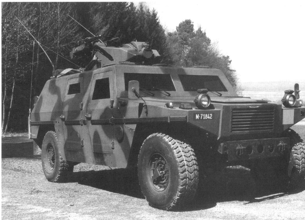
Le Véhicule d'Exploration 93, vue de face du prototype. Nettement visible, le tourelleau avec l'appareil de vision thermique, protégé par un couvercle manœuvré depuis l'intérieur du véhicule. La vitre latérale du copilote a été agrandie pour donner un meilleur angle de vision au pilote. Ce véhicule est équipé d'un système de régulation de la pression des pneus, qui ne sera pas repris sur le véhicule de série. [Photo Mowag]
