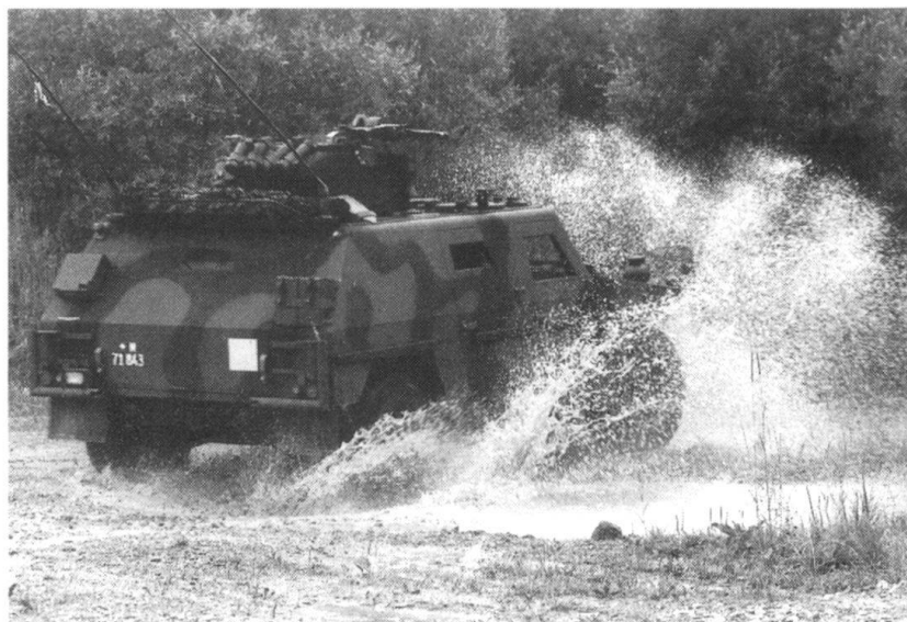
Vue de l'arrière du véhicule. A l'arrière de la tourelle, les lances-pots fumigènes (identiques à ceux du Leopard), qui doivent permettre au véhicule de se dégager de l'adversaire en cas de besoin. Les antennes – identiques à celles du M-113 pour des raisons de coût – seront changées lors de l'introduction de la radio SE-435. [Photo Mowag]
