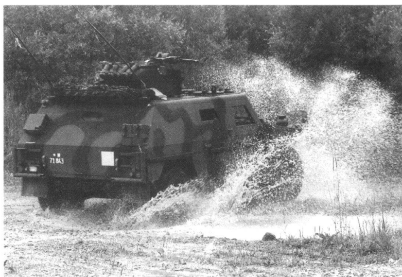
Vue de l'arrière du véhicule. A l'arrière de la tourelle, les lances-pots fumigènes (identiques à ceux du Leopard), qui doivent permettre au véhicule de se dégager de l'adversaire en cas de besoin. Les antennes – identiques à celles du M-113 pour des raisons de coût – seront changées lors de l'introduction de la radio SE-435. [Photo Mowag]
