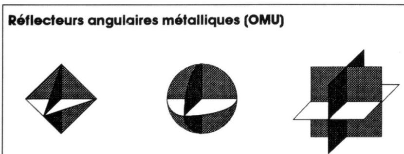
Les Russes ont développé toute une série de formes de réflecteurs angulaires qui peuvent être réalisés par la troupe avec des moyens de fortune. Ces réflecteurs peuvent être disposés de sorte à offrir la signature radar d'un char d'une station radar ou d'un poste de commandement mobile.
