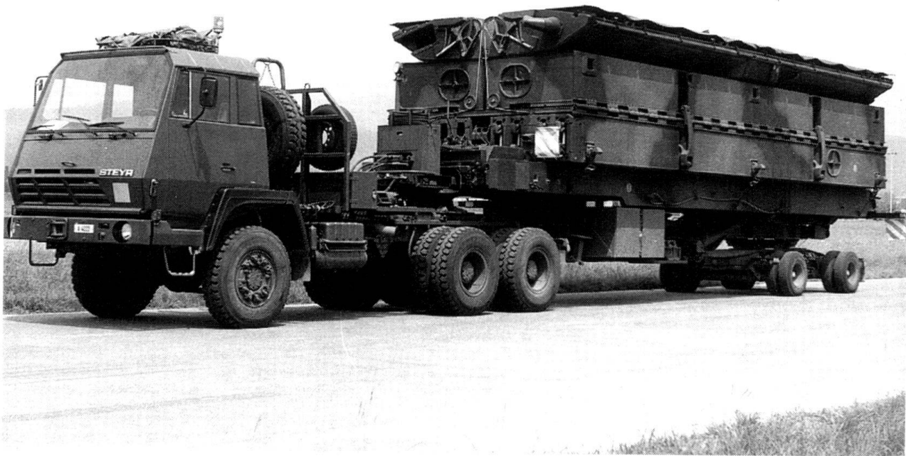
Pont flottant motorisé 95. Module de pont chargé sur camion.
