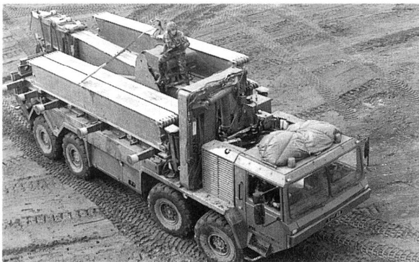
*ABLE (Automotive Bridge Launch Equipment)*, et deux véhicules qui emportent deux éléments de ponts, de chacun 32 mètres de long. *ABLE* lance d'abord un rail mince à travers la brèche, sur lequel il treuille ensuite les éléments du pont.
