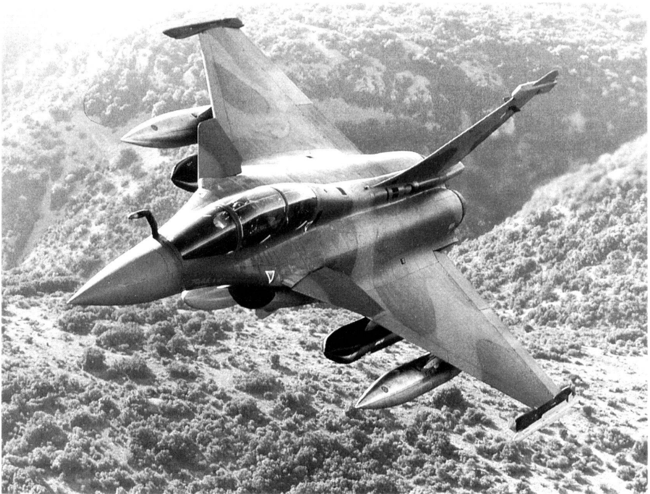
Rafale B 01. La charge maximale au décollage est portée à 22,5 tonnes.
