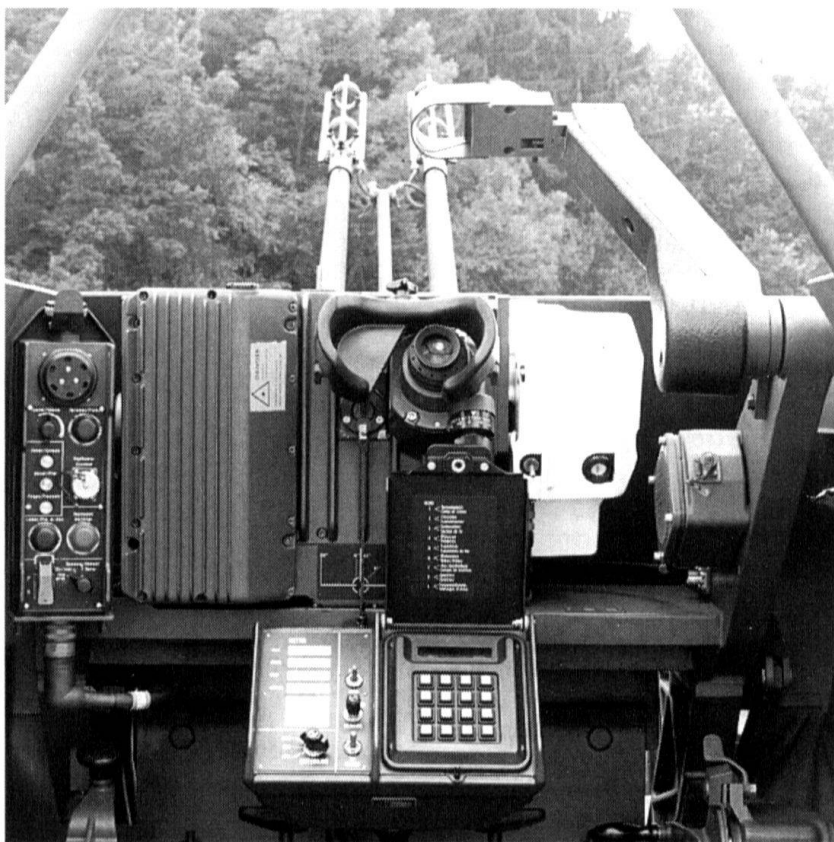
Le nouveau « cockpit » du tireur sur le canon DCA 35 mm 63/90.
