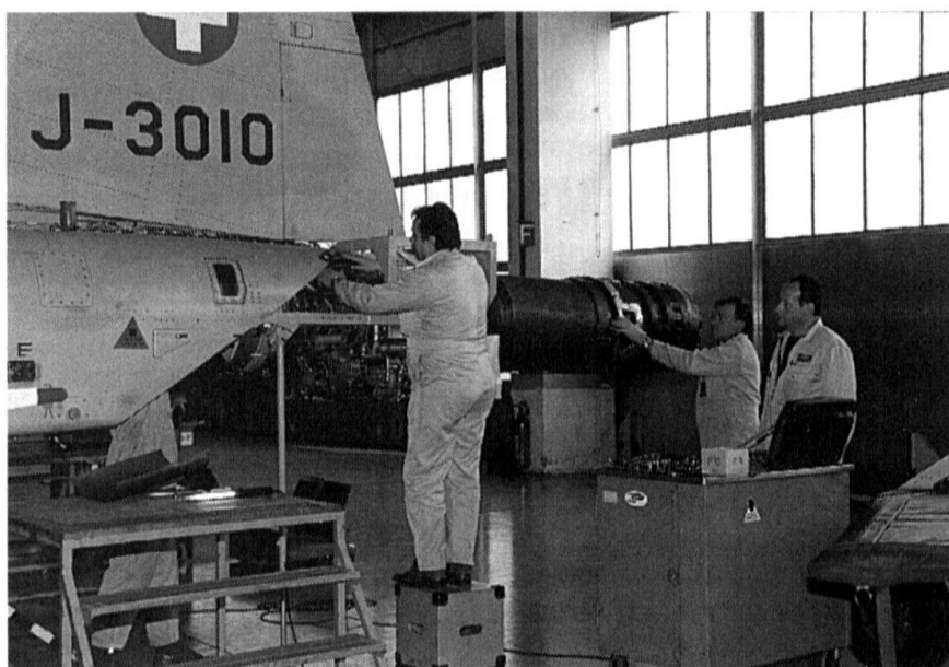
Dépose d'un réacteur de Tiger F-5. (Photo: M.-M. G.)
