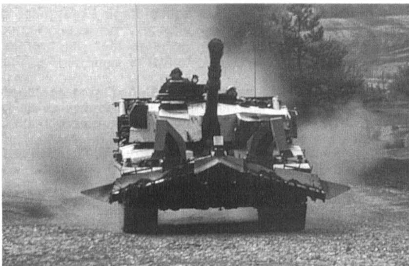
Un Challenger britannique équipé d'un dispositif de déminage (Courtesy British Army).
