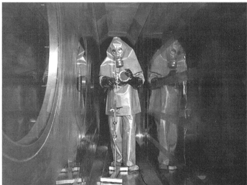
Vue intérieure du tunnel d'essais dynamiques de CEB, pour l'étude du comportement en dynamique et sous atmosphère toxique de moyens de protection et de détection (Photo : DGA/ET CA/CEB).
