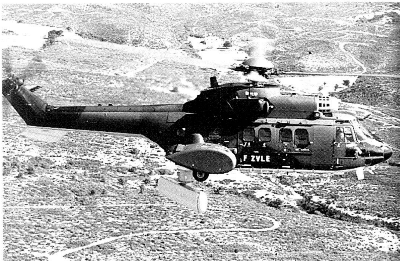
Un hélicoptère Cougar avec l'antenne radar déployée (photo : J. Deulin).
