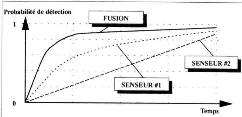
but pendant la phase où l'Awacs est momentanément « aveugle » (rotation de l'antenne-radar). Le but est alors localisé grâce à ses émissions électromagnétiques. La fusion de données fournies par des satellites et d'autres capteurs aéroportés ou terrestres s'avère également possible.
