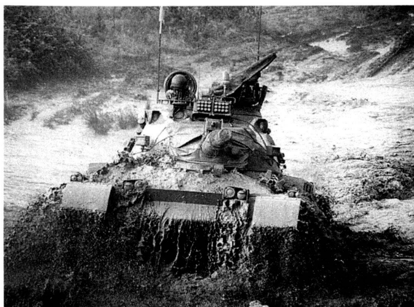
... 186 Char 68 non modernisés. Ici avec le simulateur de tir monté sur la tourelle.
