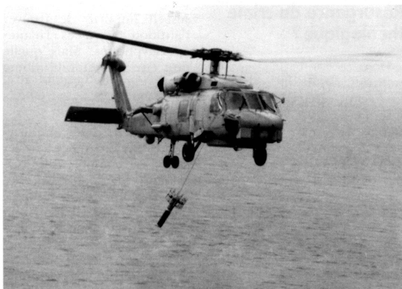
Sonar hélicoptère de basse fréquence pour la détection de sous-marins, développé par la firme Hughes en collaboration avec Thomson Sintra Activités sous-marines (Photo: Hughes).
