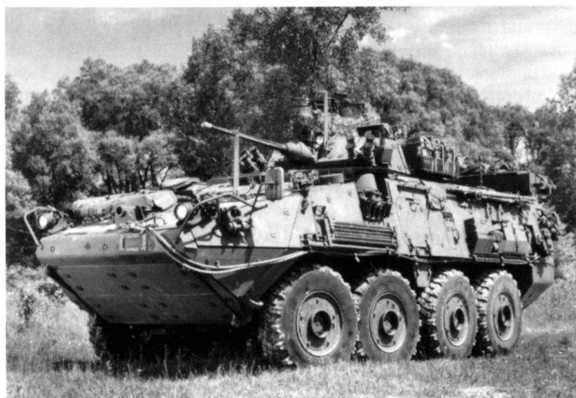
Le Kodiak de l'infanterie mécanisée canadienne est équipé d'une tourelle Delco avec canon de 25 mm (Photo: Mowag)
