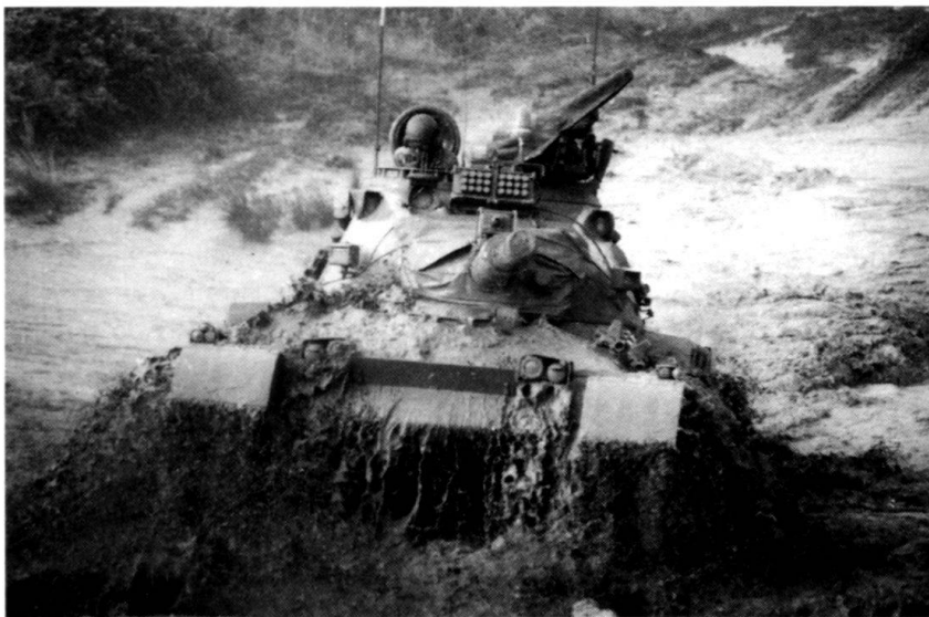
Char 88 dans une mer de boue. Au sommet de la tourelle, le simulateur laser qui permet d'entraîner le duel...
