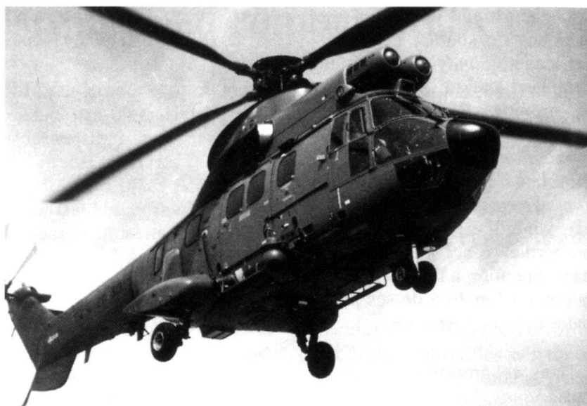
Puma équipé du système FLIR . (Photo: Thomson TRT)
