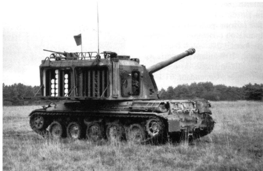
155 AUF-1T en position. Sur l'arrière de la tourelle, les casiers du dispositif de chargement automatique. (Photo: Yves Queloz)
