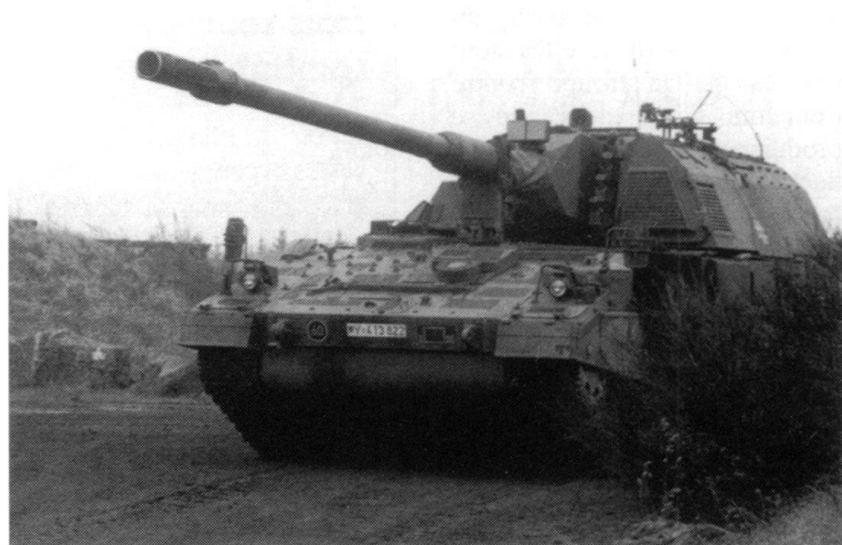
Le Panzerhaubitze 2000 de 155 mm assure l'appui de feu pour les opérations immédiates. Il se caractérise par une grande précision et une grande portée pratique.
