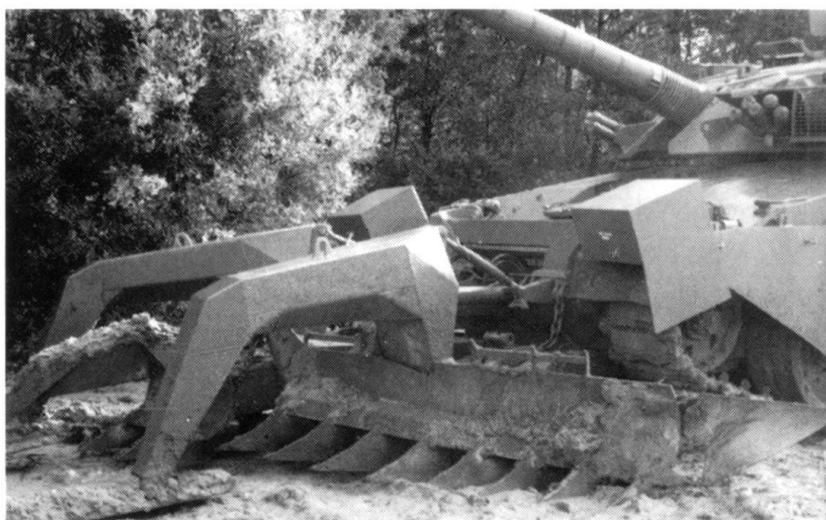
Demeter déclenche les mines à senseur électromagnétique 5 mètres en avant du char et 2,5 mètres de chaque côté. En association avec ce système, une charrue permet de neutraliser les mines posées et/ou enfouies. (Photo: Giat Industrie)
