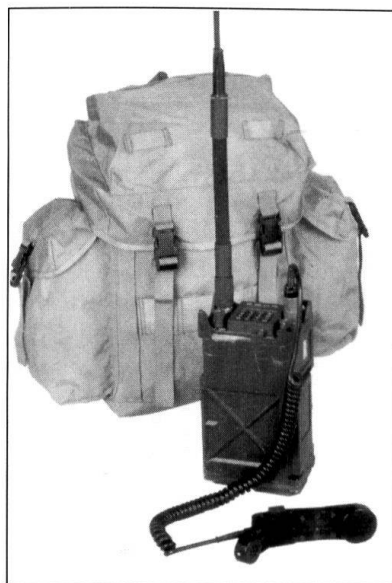
AN/PRC-119E, la version portable du SINCGARS d'ITT. Le même appareil est couplé à un amplificateur pour être monté dans un véhicule.
