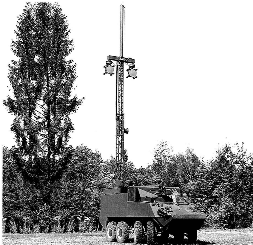
Char RAP avec mât intégré et antennes montées fixes.
