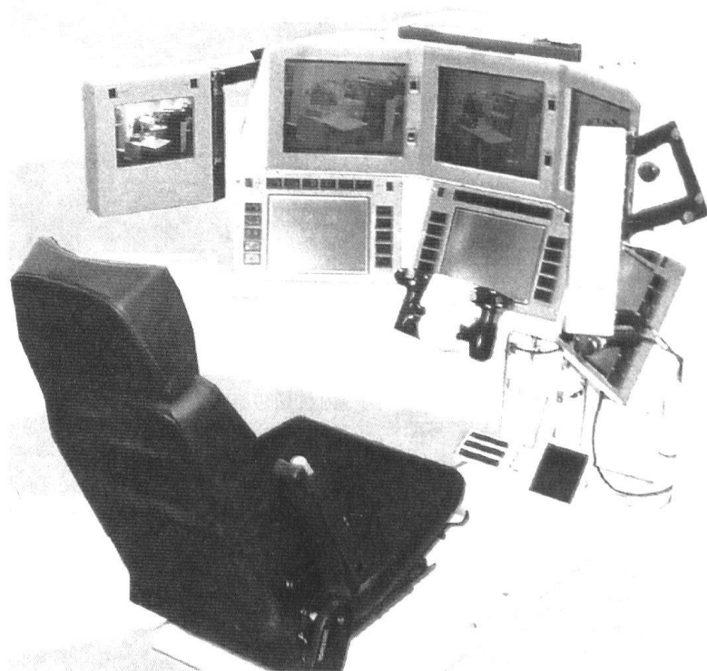
Projet de place de travail modulable, destiné au char à deux hommes (Ve-tronics).
