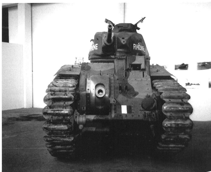
Char lourd B1, avec un canon de 75 installé à l'avant du châssis. (Musée des blindés à Saumur)
