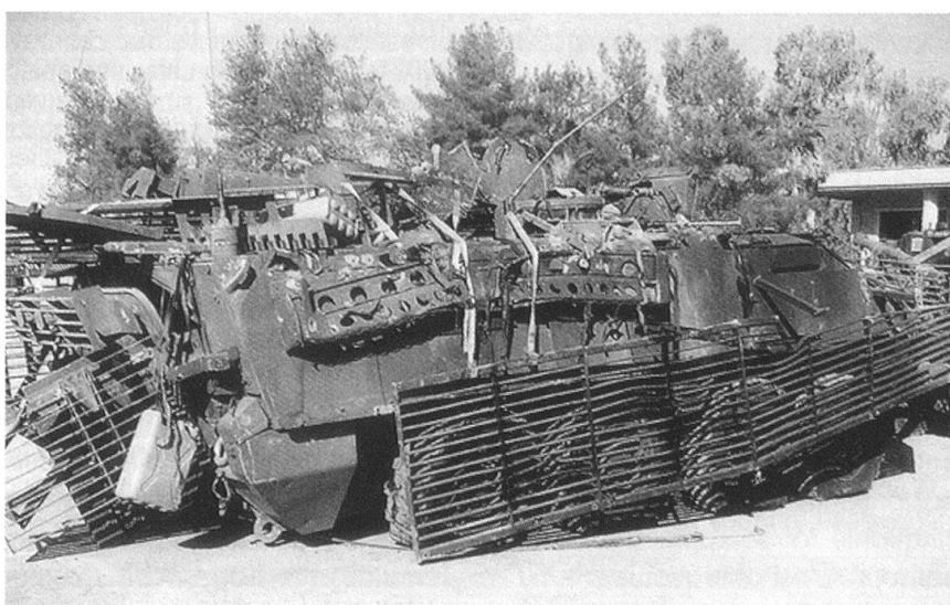
Styker endommagé par une «side-bomb» de 200 kg, une charge explosive disposée au bord d'une route.
