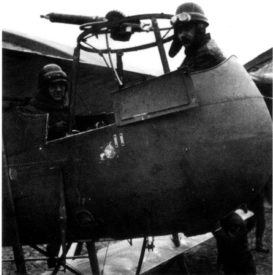
Morane-Saulnier type H de 1915 avec le déflecteur d'hélice permettant le tir vers l'avant.
