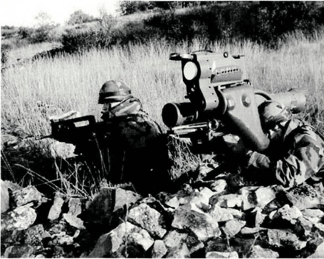
Les premières versions du Milan européen étaient encombrantes, notamment en raison de l'ajout d'un système de vision thermique. Mais il est efficace de 200 à 2000 mètres.
