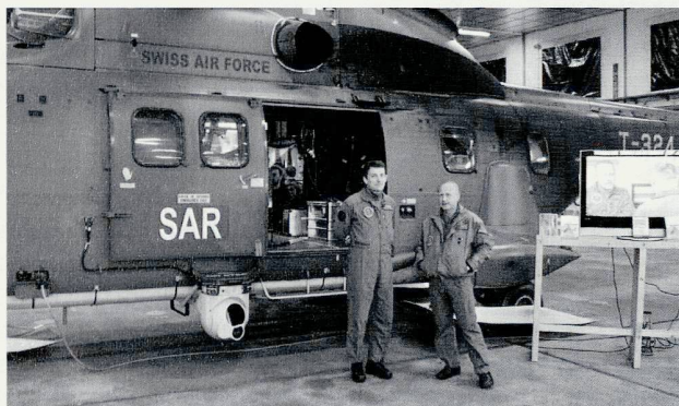
Le FLIR ( Forward Looking Infrared ) est une caméra thermique montée sur un Super Puma ou un drone, qui peut être utilisé pour la recherche et le sauvetage (SAR) de victimes.
