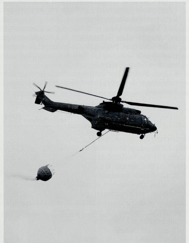
Le Super Puma peut être porter jusqu'à 4 tonnes de charges extérieures : ici, un conteneur à eau est utilisé pour la lutte contre les incendies.
